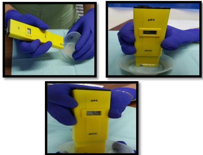
Fig. 3 Toma de lectura con medidor de pH digital
